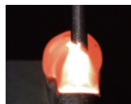
金属3Dプリンタの 溶融プロセス
