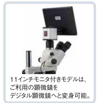
Cマウントで 顕微鏡へ簡単装着。
