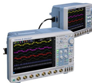
DLMsync 最大16ch同期測定
