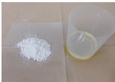
セラミックス粉末と専用UV硬化樹脂
