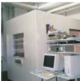
C大学研究室 脳波測定室 電磁シールド 仕様
