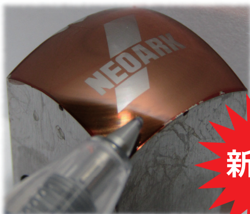
R=15mm の球面への露光例
