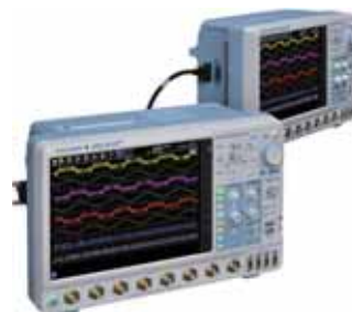
DLMsync 最大16ch同期測定
