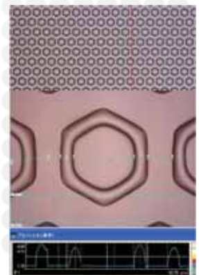
レジスト材 ライン幅: 7 μm 厚み: 2 μm ピッチ: 12 μm
