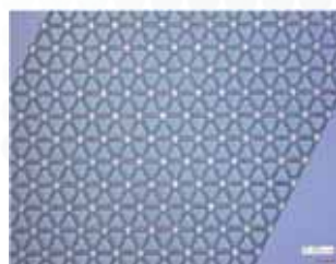
銀ナノインク ピッチ15 μm
