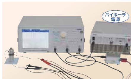
ランジュバン型圧電素子の共振特性測定
