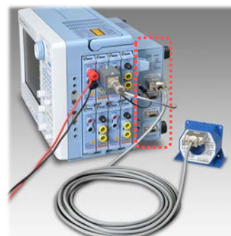
電圧入力端子形状 (メス型) 電流入力端子形状 (オス型) 760811+760812モジュール 電力測定エレメント
