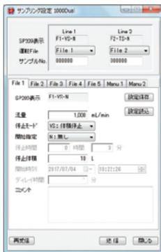
SP209 用 Assistant をインストールした PC と、SP209 を USB ケーブルで接続すると、PC から採取条件ファイルの編集・書き込み読み込みが行えます。SP209 の操作性を向上し、運転中の各種データ記録の読み出しなど行えます。
