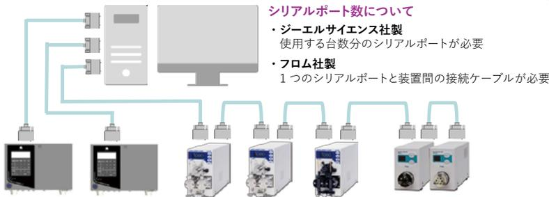
ジーエルサイエンス社製ポンプ 2 台、フロム社製ポンプ 3 台、切替バルブ 2 台の接続例
