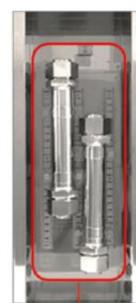
外径20 mm × 長さ250 mmを2本設置した例
