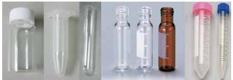
5mL バイアル、マイクロチューブ、マイクロチューブ、1.5mL/2mL HPLC 用サンプルバイアル、ファルコンチューブ/コニカルチューブ etc...
