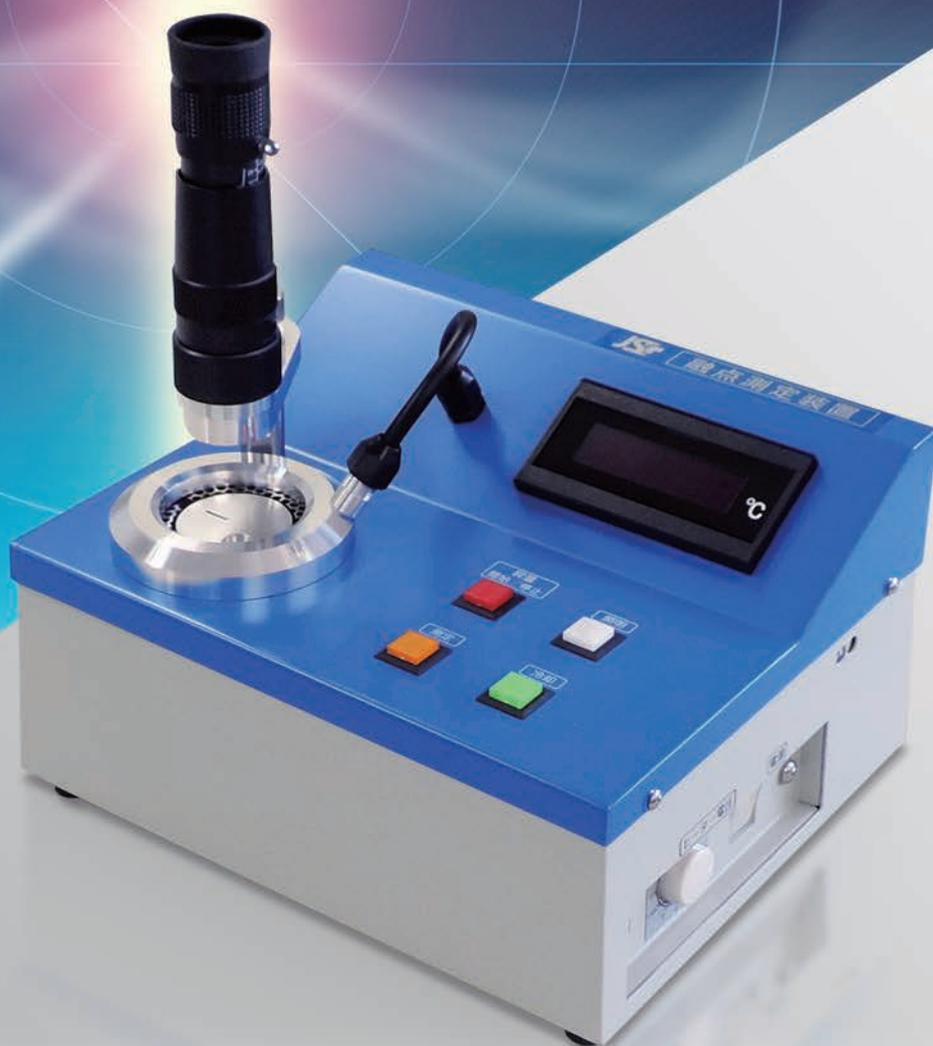
カバーガラスに挟まれた粉体試料の溶解点を顕微鏡下で目視観察し
