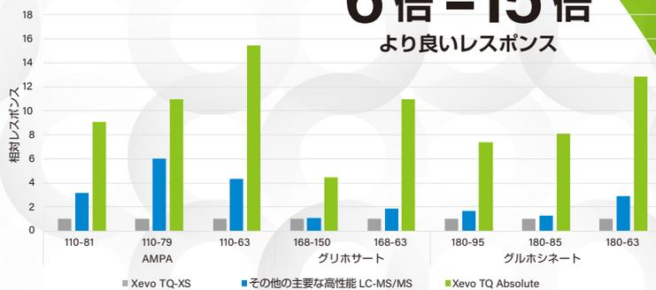
\* Xevo TQ Absolute は Xevo TQ-XS と比較して最大 15 倍の優れたレスポンスを示し、その他の主要な高性能 LC-MS/MS 装置よりも最大 6 倍の優れたレスポンスを示します。
