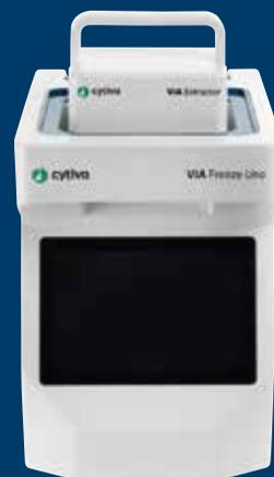
がんなどの固形組織を生存可能なシングルセルへと分散する閉鎖系の自動化システムです。従来法(マニュアル)に比べ、シングルセル解析に使用するサンプルの調整時間が短縮でき、冷却/加温しながらの分散が可能です。VIA Extractor™は、穏やかな組織分散プロセスで細胞生存率や再現性を向上し、シングルセル研究をスピードアップさせます。
