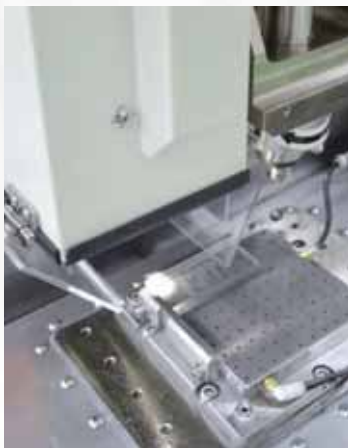
▲マイクロスフェアアレイ微細穴加工 材質：アクリル Φ0.3mm×d0.3mm
